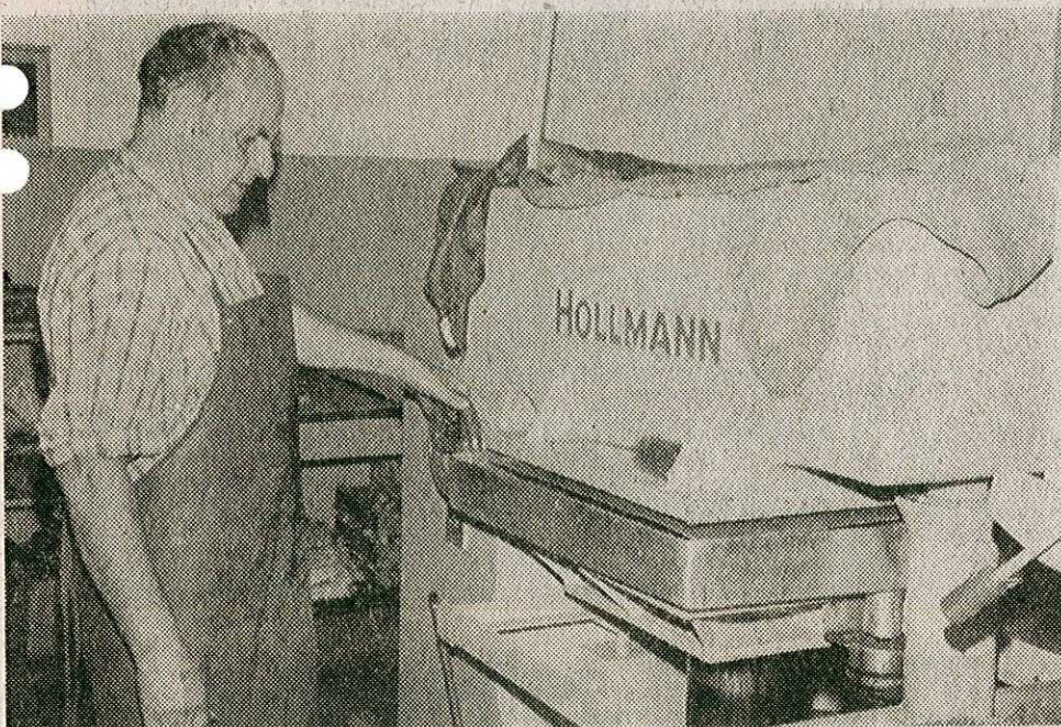
BEI EINEM DRUCK von 300 Kilogramm pro Quadratzentimeter wird das zu einem Brei zerschnittene Obst ausgepreßt. An der Maschine Albert Schlögel, der Leiter der Bobinger Mosterei.
