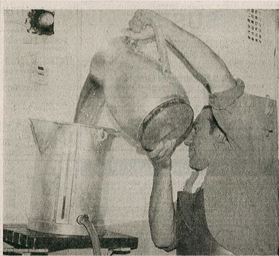
NACH DER FILTRIERUNG wird der Most auf 85 Grad Celsius erhitzt, damit der Saft keimfrei in die Flaschen abgefüllt werden kann.
